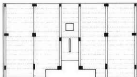
Planta simétrica, disposición simétrica de pórticos paralelos
